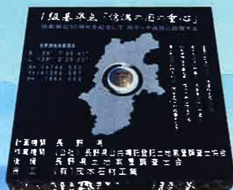
高ボッチ高原に設置された公共1級基準点「信濃の国の重心」
